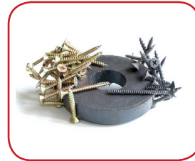
Mıknatıs vidaları temas gerektirmeyen kuvvet ile çeker.
