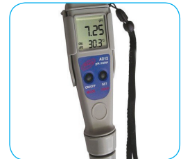
pH metreler ile çözeltilerin pH değeri hassas bir şekilde ölçülebilir.
